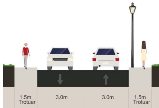
Figura 158: Profil transversal pentru colectoare secundară – categoria a III-a. Prund Șchei. Propunere
